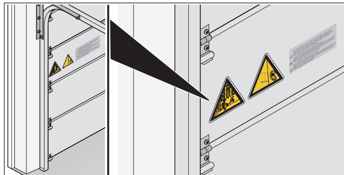
Fig. 1.2 Colocar el adhesivo en la hoja de la puerta
